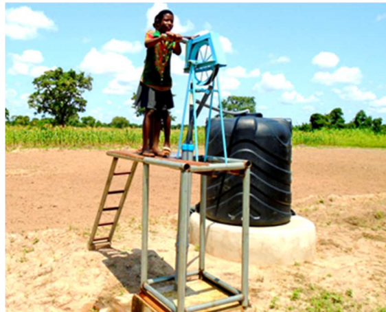
Touwpomp en tank in bedrijf
